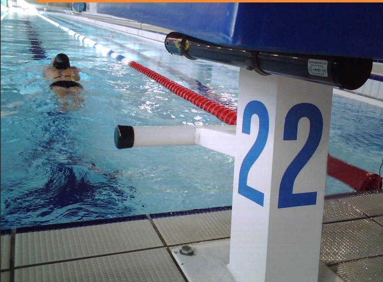
Sa faible consommation en énergie permet un fonctionnement 24h/24. La balise Tx ECO est idéale pour la natation. Il suffit de l'installer sous les plots de départ. Il est également possible de l'utiliser en athlétisme en la plaçant en bordure de piste. Le champs d'émission est de 2m.
